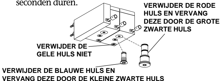
Afb. 11. Ombouw naar droog besturingsblok
